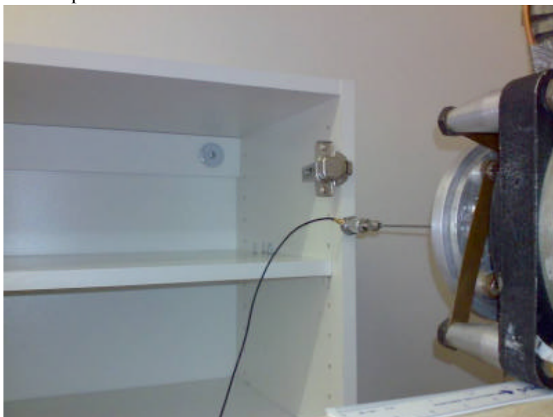
Figur 22. Montering av vibrator mot skåpstomme, nära gångjärn.
